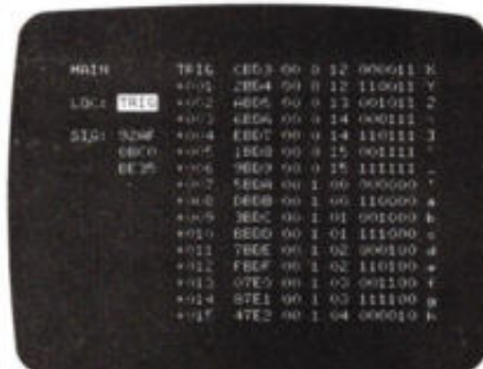
Afb. 4. Weergave van 48 kanalen van status-data, in elke combinatie van hexadecimale, octale, decimale, binaire en ASCII-formaten.
