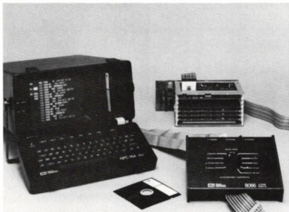
Afb. 6. NPC-764 met real-time disassembly-eenheid voor microprocessor 8086.
