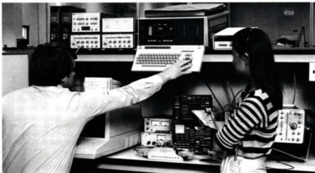
De HP 4955A Protocol Analyzer vereenvoudigt systeemontwikkeling en geeft aan waar bijgeregeld dient te worden.
