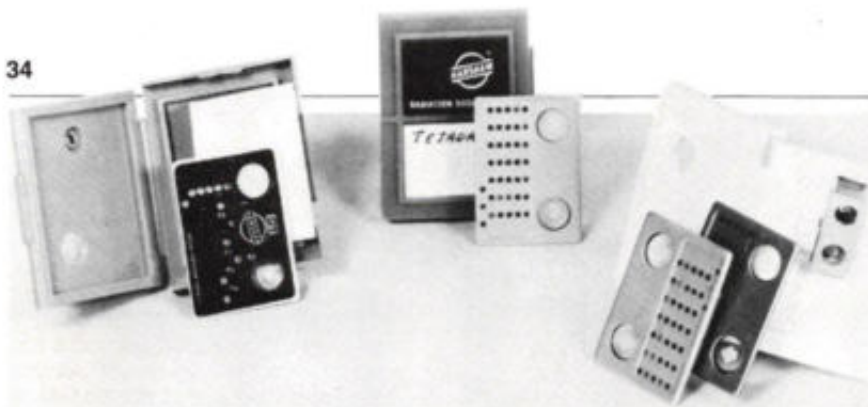
Afb. 6. Dosimetrische film-badges van Harshaw bevatten kristalschijfjes in de bovenhoeken, met stralingsabsorptie-eigenschappen, identiek aan die van menselijk weefsel.
