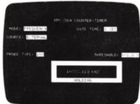
Afb. 10. Frequentiemeting in de „counter/timer”-modus. Behalve de omkaderde frequentie-uitlezing, geeft het beeldscherm uitgebreide informatie zoals de gemeten signaalbron (intern/extern), poorttijd, drempelspanning en gebruikte meetstift (in dit geval een 1:10-verzwakker).
